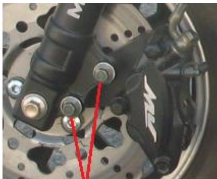
پیچهای اتصال کالیپر به کمک فنر جلو پیچهای آلنی قفل کننده
