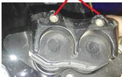
پیچهای اتصال کالیپر به کمک فنر جلو پیچهای آلنی قفل کننده
